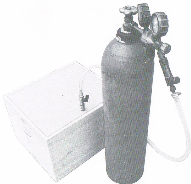
Abb. 18: Anschluß Kohlensäureflasche zum Deckel
